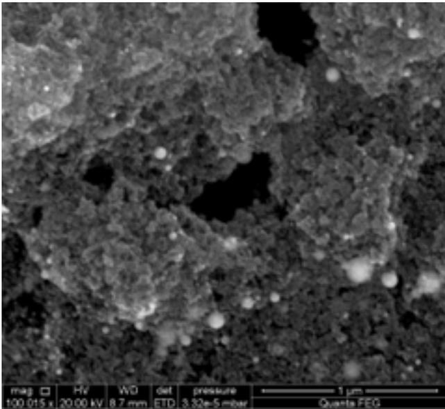
Abbildung 2: EM-Aufnahme: Gold- und Titanoxid-Nanopartikel
